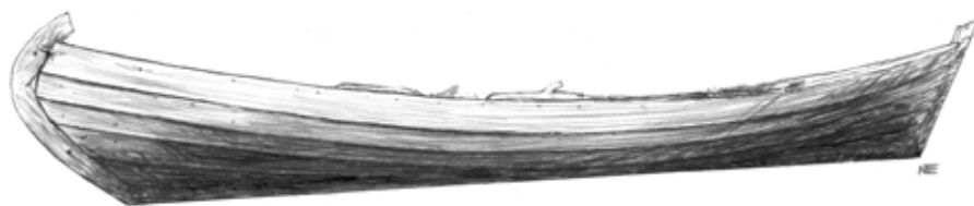
Fig. 3. Schnjakas är traditionella ryska fiskebåtar. De var vanligtvis sydda och hade en väldigt karaktäristisk förstäv som påminner om fartyget från Magalottis handskrift (teckning av författaren efter bilder av ett bevarat exemplar i Norsk maritimt museums samlingar).
