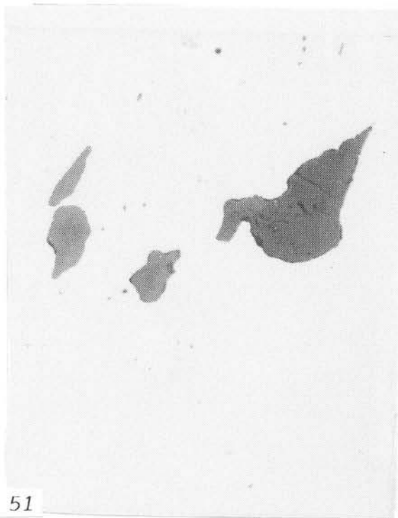
Fig. 49 Mikrostruktur i snitt C_A . Sk 400:1 Ferrit och perlit (mörk). Den senare är något "urartad" p g a glödningspåverkan.
