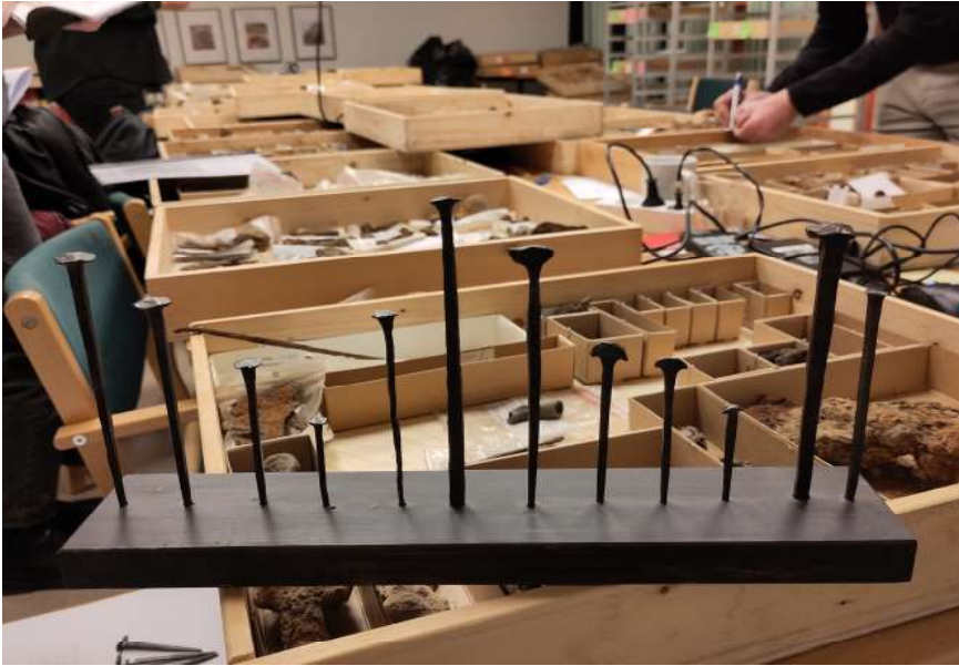
Figur 2. Diskussionerna vid workshopen utgick delvis från järnfynd från kvarteren Gesällen och Mästaren i Kalmar. I förgrunden spik som Magnus Sjöholm samlat in i samband med renoveringen av ett 1700-talshus i Visby. Foto Linda Qviström.
