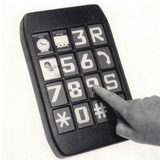
Figur 3. Knappsats med stora tangenter som kan förprogrammeras för kortnummerfunktion.
