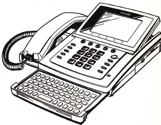
Figur 4. Skärmtelefonen är en kombination av telefon och tangentbordsterminal. Talsyntes som tillsats för läshandikappade personer skulle öka användbarheten.
