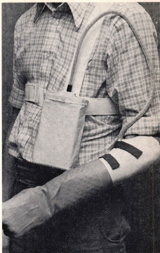
Fig. 4: Elektromyografiskt styrd handprotes för underarmsamputerad.
